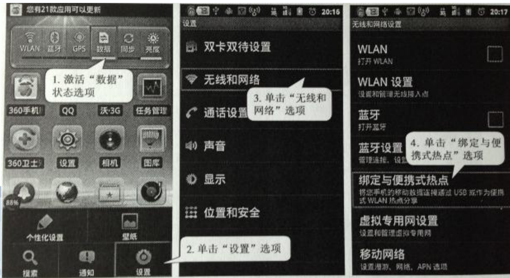
图3-5 (a) 设置3G手机WLAN热点操作步骤
